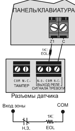
Н.З. Контакты, без EOL резистора с распознаванием тампера
